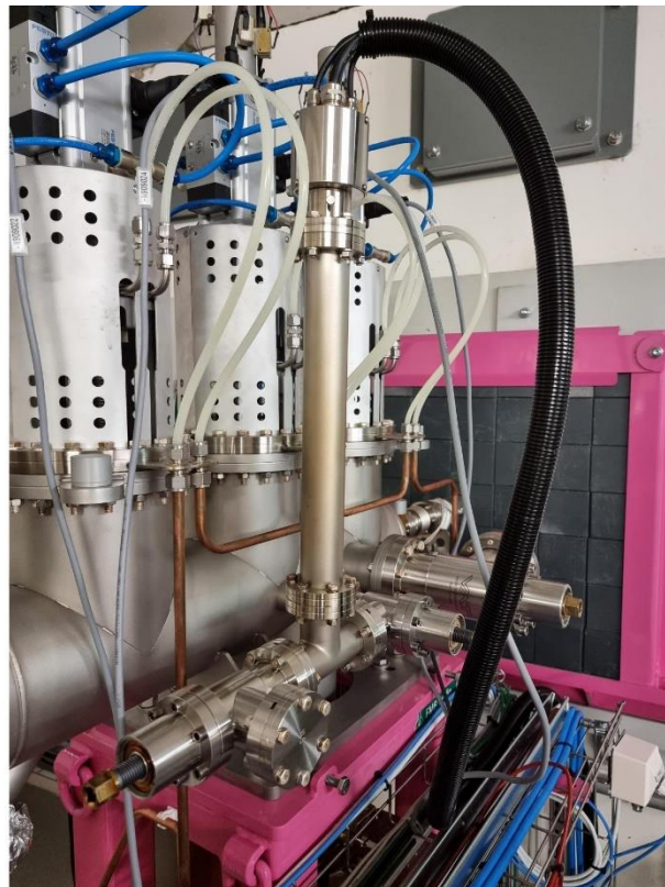
Analizatory gazów resztkowych HIDEN HAL 101 RC zamontowane na front-endach
