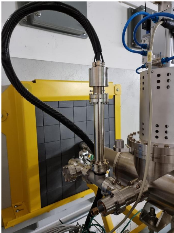
Analizatory gazów resztkowych HIDEN HAL 101 RC zamontowane na front-endach
