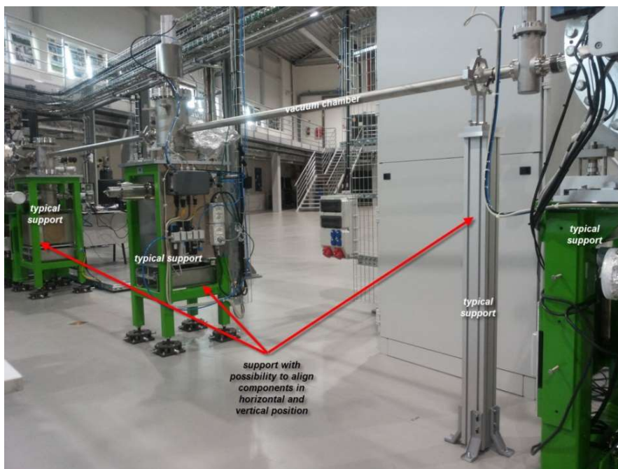
Rys. 3. Przykładowy system wsparcia komór próżniowych przy wykorzystaniu metalowych podpór.
